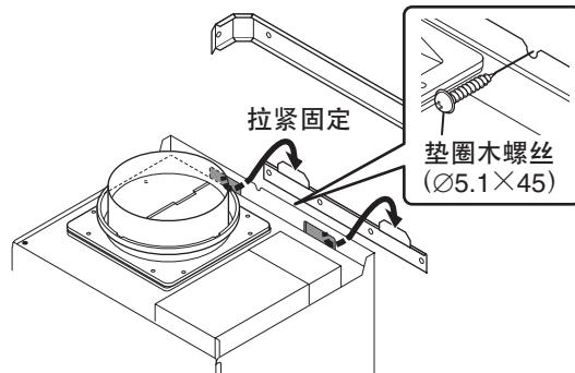
4) 将排气管的 4 个凸起对准排气口的凸起、插入, 按逆时针方向略转动。
