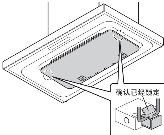
12) 将油杯安装在整流板上。
